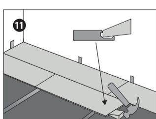
Querverbindung: Legen Sie nun den Schlagklotz auf das Profil und schlagen Sie es durch moderates Schlagen in die Nut-Feder-Verbindung der Stirnseite. Dieses Vorgehen kann für den gesamten Raum fortgeführt werden.
