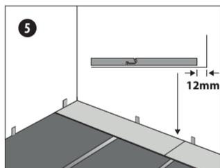
Entfernen Sie bei der ersten Produktreihe die Feder zur Wand. Lassen Sie zur Wand einen Abstand von ca. 12mm.
