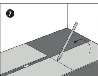
Markieren Sie das letzte Produkt der Reihe und markieren Sie dieses auf der Rückseite. Schneiden Sie es nun so zu, dass die erste Reihe liegt ist. Das übrig gebliebene Stück wird den Anfang der zweiten Reihe bilden.
