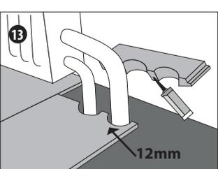
Müssen Sie einen Ausschnitt für Heizkörperrohre, Pfeiler, Trennwände oder sonstiges vornehmen, dann achten Sie auch dort auf den ca. 12mm Abstand zu den Bauteilen.
