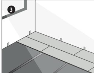
Die Empfohlene Verlegerichtung ist längs zur Hauptlichtquelle. Die größtmögliche zusammenhängende Verlegefläche beträgt 8m in Richtung Breite und 8m in Längsrichtung. Zu Wänden, größeren Flächen und Räumen müssen passende Bewegungsfugen berücksichtigt werden.
