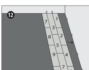
Verlegen Sie das Produkt im Raum gemäß der Nummerierung in der Abbildung. Die erste Reihe ist bei Bedarf anzuschneiden. Im Anschluss schieben Sie die vorinstallierten Reihen an die Wand. Der Abstand wird durch die Abstandskeile fixiert. Danach kann die Verlegung Reihe für Reihe fortgeführt werden.
