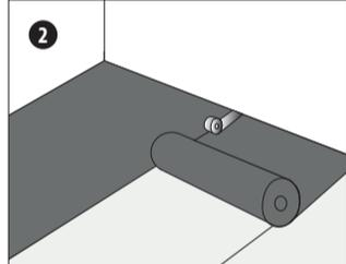
Verlegen Sie nun die Dämmunterlage quer zur Verlegerichtung des Produktes. Legen Sie die Bahnen bündig aneinander und vermeiden Sie dabei Abstände. Verkleben Sie die Bahnen mit Fugendichtband.
