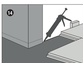
Wo mit erhöhter Feuchtigkeit zu rechnen ist, welche auch hinter Fußleisten, Türrahmen usw. eindringen kann, müssen abgedichtet werden. Über die Bewegungsfuge wird eine 13mm komprimierbare Polyethylen-Rundschnur gelegt, welche anschließend mit Silikon zusätzlich abgedichtet wird.
