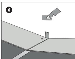
Die Produkte der ersten Reihe werden zuerst an der kurzen Stirnseite verbunden. Es wird in einem Winkel von 25° angesetzt und eingeschwenkt. Achten Sie darauf, dass diese auf der Stirnseite exakt gerade ausgerichtet sind.
