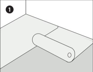
Verlegen Sie zum Schutz gegenüber aufsteigender Feuchte eine Aquastop Folie (Polyethylen-Folie). Die Folie sollte an den Wänden ca. 2cm hochgezogen werden und an den Stoßfugen ca. 2cm überlappt und verklebt werden. Enthält ihre Dämmunterlage bereits eine Aquastop Folie, ist dieser Schritt zu übergehen.
