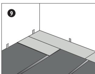
Das übrig gebliebene Stück winkeln Sie flach mit der Feder so weit wie möglich in die Längsseite der vorherigen Produktreihe ein und drücken es langsam herunter, sodass es spürbar einrastet.
