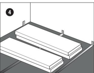
Bereiten Sie mindestens vier Pakete vor und wechseln bei der Verlegung zwischen diesen. Hierdurch wird ein ideales Verlegebild erzeugt.
