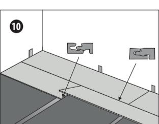
Längsverbinding: Das nächste vollstständige Produkt in einem Winkel von ca. 25° eingeschwenkt und noch vor dem Einrasten stirnseitig dicht an das vorherige Produkt geschoben. Drücken Sie es langsam einrastet, sodass die Längsseite spürbar einrastet.
